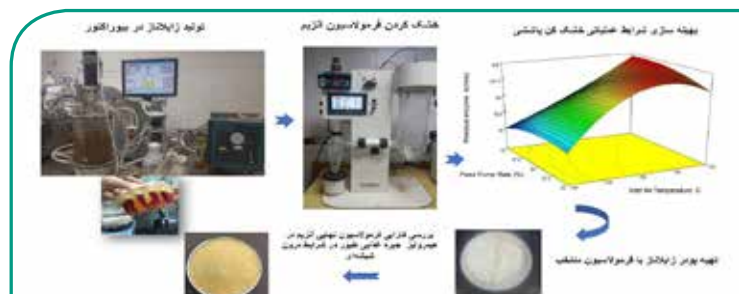
فرمولاسیون و خشک کردن آنزیم زایلاناز به روش پاششی
